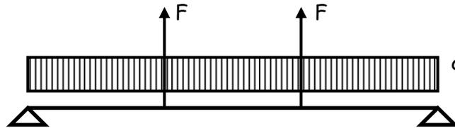
Il valore della forza concentrata verticale, derivante dalla deviazione del tracciato del cavo, si determina come segue:
